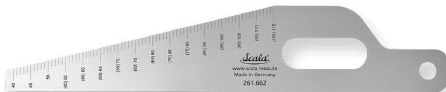
Messkeil/Prüflehre mit beidseitiger Duplex-Teilung für Gleitbacken-Querabstand am Radsatz 40 – 115 mm für Federbockbreite 90 mm, 40 – 100 mm für Federbockbreite 120 mm (Art.-Nr.: 261.662)
