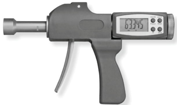
Dreipunkt-Innenmikrometer mit Pistolengriff, zwei Messköpfen und Einstellring, Abl. 0,001 mm, Genauigkeit 0,004 mm für Innendurchmesser-Messungen an Radsatz-Kugellagern (Art.-Nr.: 261.641)
